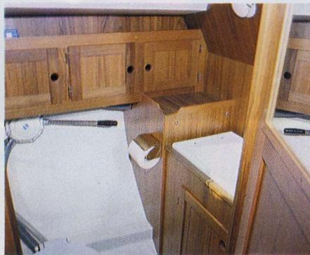
Questo è il locale W.C. con doccia. È visibile il sistema W.C. a depressione tipo «Lavac». A mio parere è ottimo. Si noti l'abbondanza di rivestimenti in compensato di teak. Mixer dispone di casse per le acque nere.
